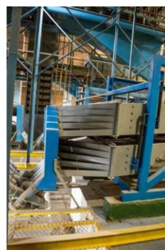
CONJUNTO DE ESPIRAL (ESQ.) E CONJUNTO DE PADRONIZADORES POR PENEIRAS (DIR.) PARA CLASSIFICAÇÃO DE GRÃOS – UNIDADE DE BENEFICIAMENTO DE SEMENTES
