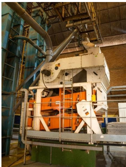
MÁQUINA DE PRÉ-LIMPEZA UNIDADE DE BENEFICIAMENTO DE SEMENTES
