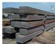
Produto Bloco dos lingotamento contínuos, sobre prisa de madeira serrada. Peso do bloco 4.730 kg
