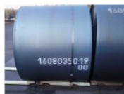
Produto Bobina de Placa, pronta para embalar, amarrada com fita de aço e o aço de fixação. Peso da bobina 54.590 kg
