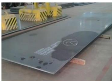
Produto chapa de aço, sobre madeira de serrada. Peso da chapa 2.180 Kg
