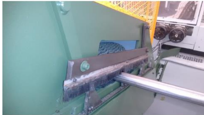
Figura 10b – Removedor de rebarbas
