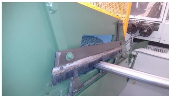
Figura 10b – Removedor de rebarbas
