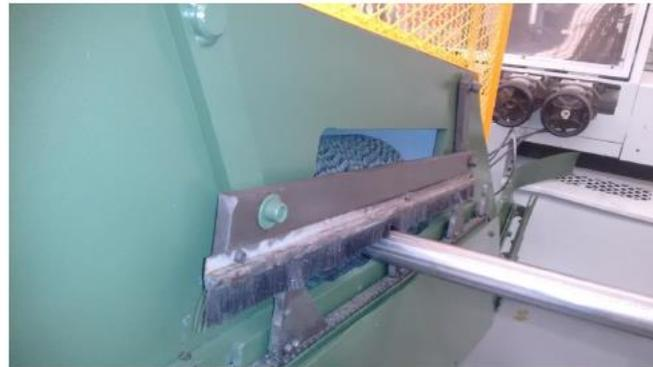
Figura 10b – Removedor de rebarbas
