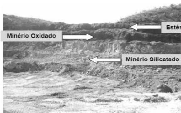
Figura 1: Vista da mina (camada superior de estéril, camada vermelha de minério oxidado e região branca de minério silicatado).
