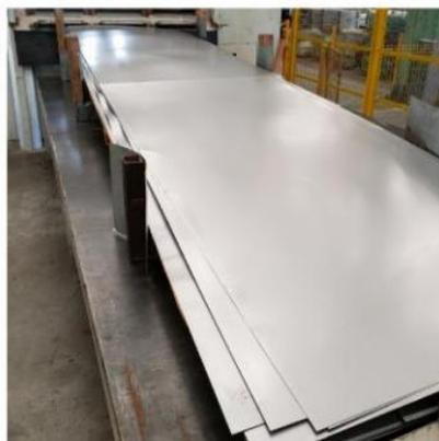
**FIGURA 29** – Chapas cortadas a partir de bobina de aço laminado a frio na máquina Heilbronn, na unidade Betim-MG.
