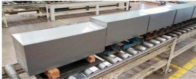
**FIGURA 24** – Blanques de aço laminado a frio, com recobrimento de zinco.
