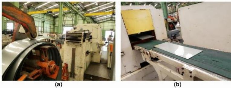
**FIGURA 26** – Cortes de blanques na máquina Setrema. (a) Entrada do rolo de aço zincado no endireitamento e aplainamento; (b) Saída de blanques cortados.
