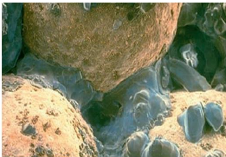
Pontes de cristais entre as partículas de fertilizante causam rachamento
