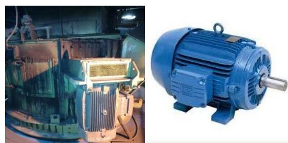
Estes motores de indução e monofásicos também funcionam aproximadamente 20 horas por dia, sendo o seu desgaste inevitável. A sua substituição ou recuperação
