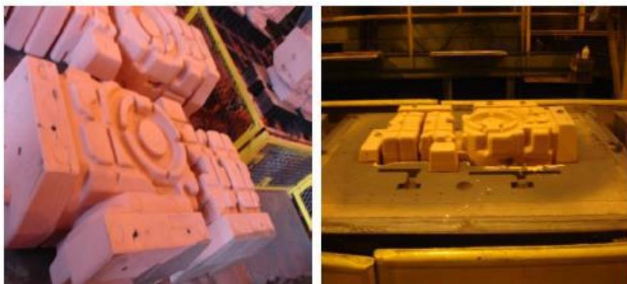
Posteriormente a esse processo de “sopro” os machos passam pela pintura protetiva e pela secagem em estufas específicas de acordo com os requisitos de cada processo.
