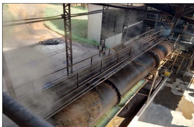
Figura 13. Sistema de resfriamento dos propantes obtidos após a sinterização.
