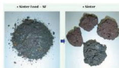
Figura 30– Produto da sinterização - Sinter.
