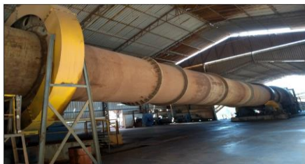
Figura 12. Forno rotativo utilizado para a sinterização dos propantes cerâmicos.
